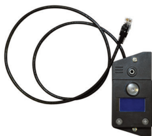
KIT E-BCU tool diagnostico (non incluso)
